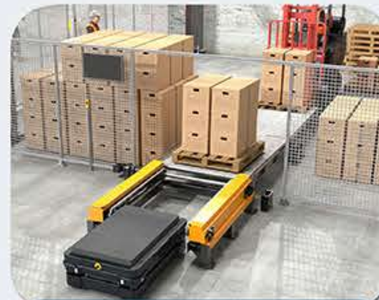
Conveyor de carga y descarga
