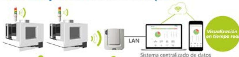
1. La torre de señal con transmisor WD se instala fácilmente en el equipo.
