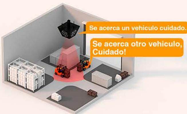
Cuando varios vehículos ingresan a la intersección simultáneamente, la etiqueta Crossway Zone emite una alerta de voz y proyecta la luz en el piso al detectar la etiqueta del vehículo.
