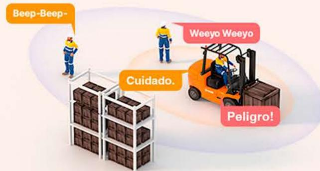
Cuando las personas ingresan al rango de precaución/peligro, Pedstrain Tag emite una alerta de vibración y sonido. Este dispositivo es configurable y recargable.
