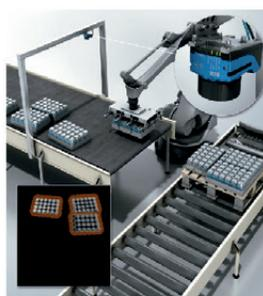
**Localiza piezas de forma rápida y fiable.** La carcasa del sistema de sensores tiene una clasificación de envoltorio de IP65. El PLOC2D se conecta directamente al control del robot o al PLC y está listo para usarse inmediatamente. La interfaz intuitiva hombre-máquina está diseñada para garantizar que el PLOC2D sea fácil de configurar y mantener en entornos de producción.
