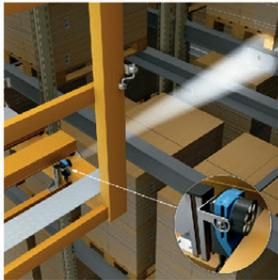
Sensor de visión flexible y fácil de usar que guía el posicionamiento preciso de transelevadores u otros sistemas de almacenamiento y recuperación automatizados en X e Y. El amplio rango de medición permite el uso de estanterías de doble profundidad con el mismo sensor tanto para distancias cercanas como lejanas.
