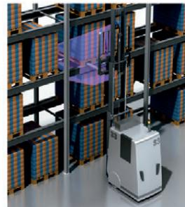
El almacenamiento y retirada de cargas mediante carretillas industriales requiere la detección precisa de espacios de almacenaje y palet, especialmente a grandes alturas. Los valores medidos necesarios para recoger la paleta se procesan previamente y se evalúan en el sensor, luego se transmiten al control de la carretilla elevadora tripulada automatizada.
