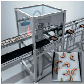
Trabajar con visión 3D en sus proyectos de guía robótica aumenta tanto la confiabilidad de su proceso de picking como la calidad de los productos manipulados. Para cada producto detectado, la cámara informa la ubicación, la altura y la orientación al controlador del robot. A petición, el script SensorApp se puede abrir y personalizar
