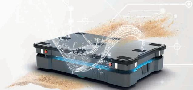
El MiR 600 es el primer AMR con clasificación IP52 en el mercado junto con otros robots de servicio pesado, el muy poderoso MiR 1350. Con una mayor capacidad para soportar polvo y fluidos.
