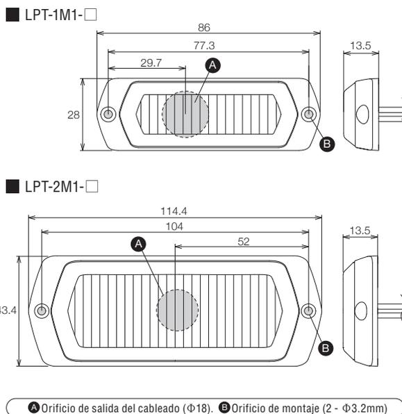
● A Orificio de salida del cableado (Φ18). ● B Orificio de montaje (2 - Φ3.2mm)
