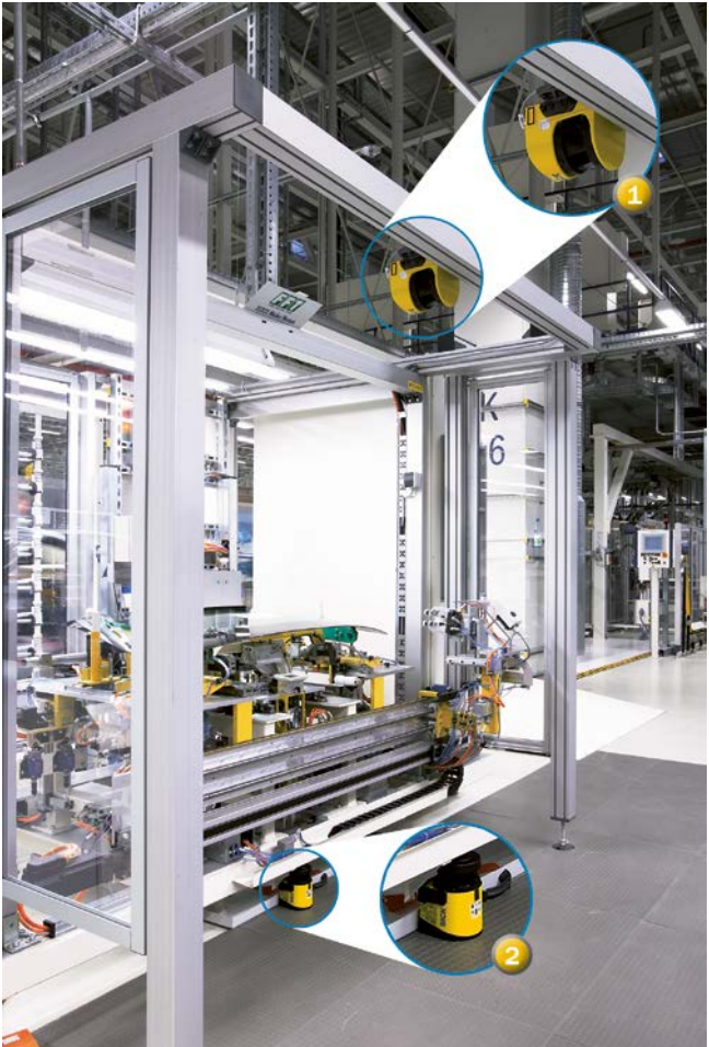
Escáner láser de seguridad en una estación de mecanizado como función de seguridad pos. 1, activar parada y función de seguridad pos. 2, impedir el arranque (detección de presencia)
