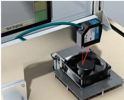
El sensor de medición de desplazamiento OD5000 mide con gran precisión objetos que rotan a gran velocidad, p. ej., una rueda de ventilador. Gracias a la alta frecuencia de medición de hasta 80 kHz, pueden detectarse vibraciones en el rango micrométrico de un dígito con fiabilidad.
