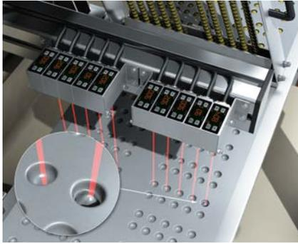
El control de las características de calidad en el proceso de producción resuelve distancias de sensores de medición de desplazamiento hasta en la zona micrométrica, p. ej. para la detección precisa de prensados deficientes de envases tipo blíster.
