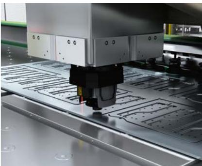
En el mecanizado de chapas, el calor y las tensiones pueden tener como resultado irregularidades en el material. Un sensor de distancia mediante láser comprueba de forma continua la distancia del cabezal de corte respecto a las planchas de chapa, para evitar colisiones.
