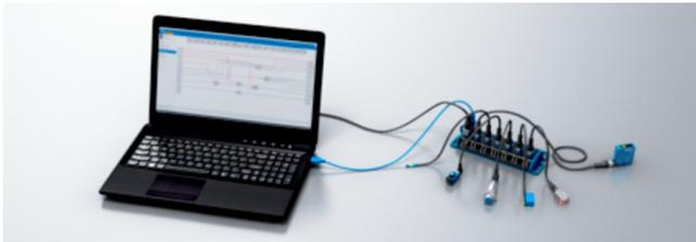
Resuelva tareas sencillas con las señales de conmutación binarias o los valores medidos proporcionados por sus sensores o actuadores, sin ningún sistema de control adicional.
