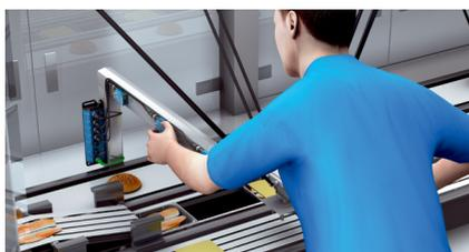
Sustitución sencilla de dispositivos gracias a la identificación automatizada: al utilizar dispositivos IO-Link en combinación con el maestro IO-Link SIG200 no se precisa de personal especialmente capacitado ni de medios auxiliares adicionales o instrucciones para poder sustituir de modo fiable los sensores.
