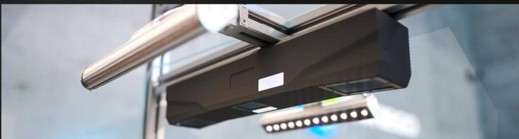
**3D Mech-Eye:** Sistema de visión industrial que diferencia el contenido de las botellas de jugo antes del empaquetado, identificando variedades como naranja, mango o manzana mediante imágenes 3D de alta resolución. Su precisión permite optimizar la clasificación automática y asegurar que cada lote llegue correctamente etiquetado y verificado.
